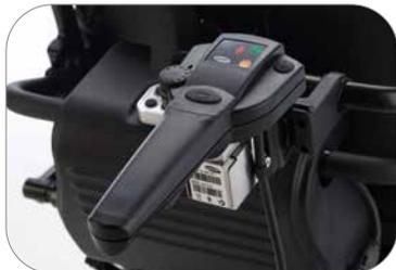
**Puoi scegliere un comando di altre aziende e utilizzarlo con il nostro sistema intelligente LiNX. In questo caso serviranno i nostri moduli di ingresso come interfaccia.**
